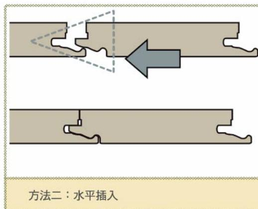
在一些很難斜拼的地方，把地板滑入所需的位置，使用鐵鎚和螺紋栓。有效、簡單，您可以完美無瑕地裝完您的最後一塊地板。
